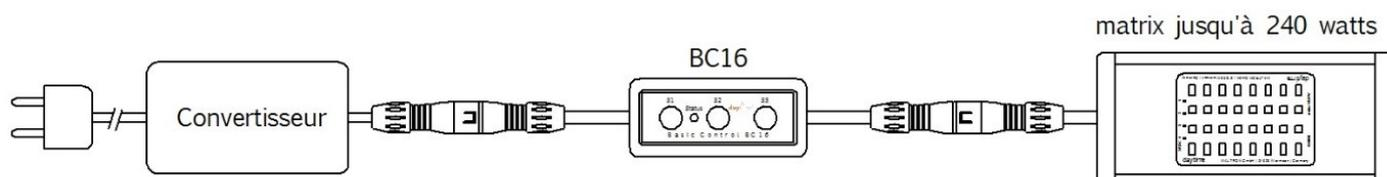
Exemple avec un convertisseur, un répartiteur double (disponible en option) et 2 lampes daytime® matrix d'une puissance totale pouvant aller jusqu'à 240 watts.
