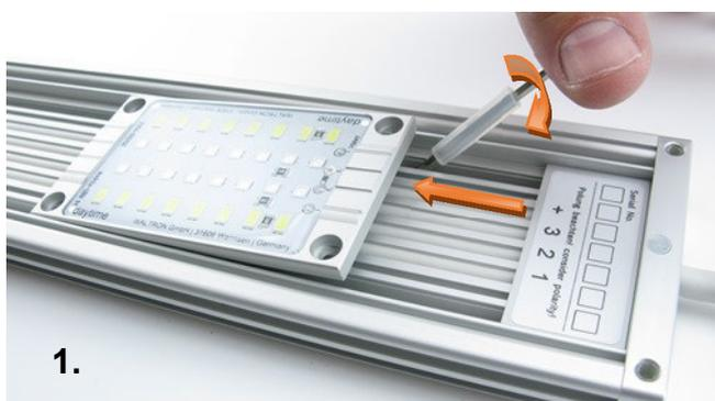
**Soulever et retirer le module en deux étapes : Introduire la branche courte et caoutchoutée de la clé spéciale dans les rainures de filetage et "extraire" le module.**
